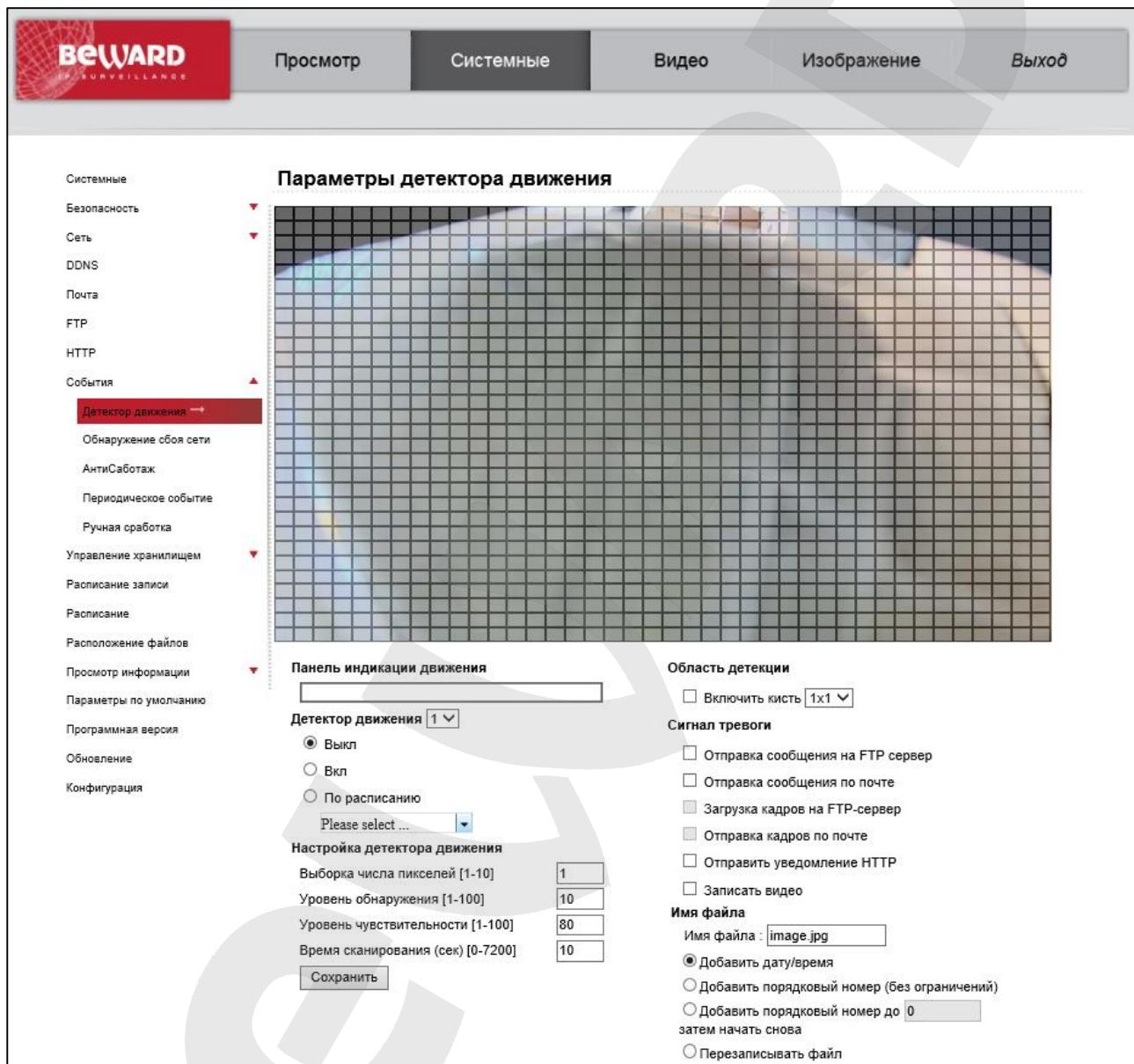
Детектор движения предоставляет возможность существенно сократить объем записи (а значит и размер видеоархива), увеличить глубину видеоархива при тех же дисковых объемах и осуществлять регистрацию при обнаружении движения в определенной зоне видеозображения. Камера поддерживает до 4-х независимо настраиваемых детекторов движения, каждый из которых определяется до 10 зонами.
