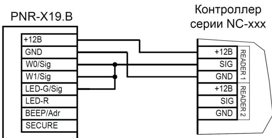
Рисунок 5. Подключение считывателя по интерфейсу Parsec, адрес 1 (внутренний)
