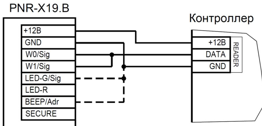
Рисунок 3. Пример подключения считывателя подключении по интерфейсу Touch Memory
