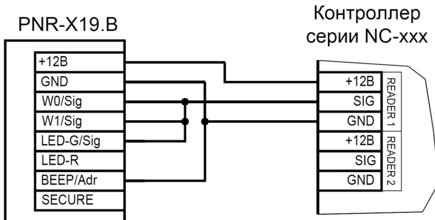
Рисунок 6. Подключение считывателя по интерфейсу Parsec, адрес 0 (наружный)
