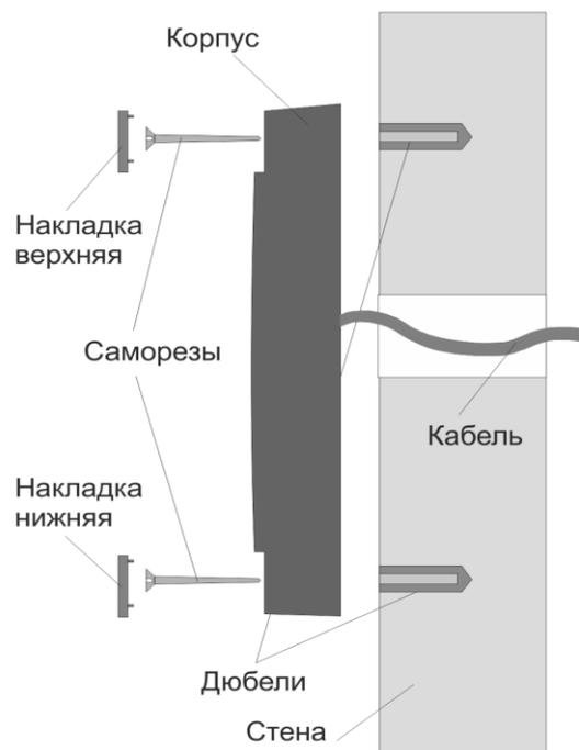
Рисунок 2. Крепление считывателя
