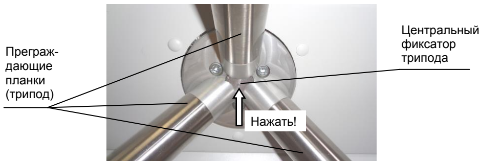
Рис.3 Место расположения центрального фиксатора трипода
