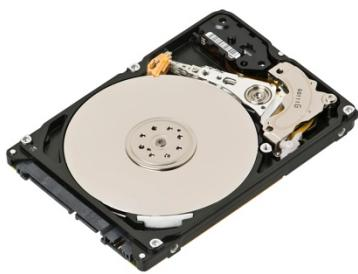
Жесткий магнитный диск - носитель данных в виде тонкого диска из немагнитного материала (обычно из алюминия, стекла или керамики), покрытого с одной или двух сторон слоем ферромагнетика. **Ферромагнетик** - вещество, способное намагничиваться, то есть под воздействием внешнего магнитного поля изменять уровень остаточной намагниченности. Это свойство используется для записи единиц информации (упрощенно 1 – намагнченено, 0 – размагнченено) на поверхность диска при помощи магнитных головок.
