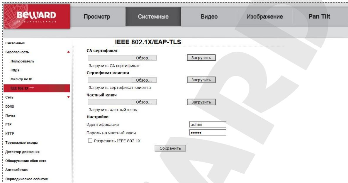
Стандарт IEEE 802.1x определяет протокол контроля доступа и аутентификации, который ограничивает права неавторизованных устройств, подключенных к коммутатору. Сервер аутентификации проверяет каждое устройство перед тем, как оно сможет воспользоваться сервисами, которые предоставляет ему коммутатор. В качестве протокола аутентификации используется EAP-TLS.
