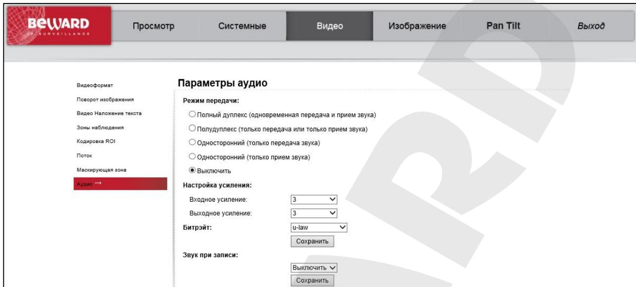
**Режим передачи (Transmission Mode):** определение режима передачи звука.
