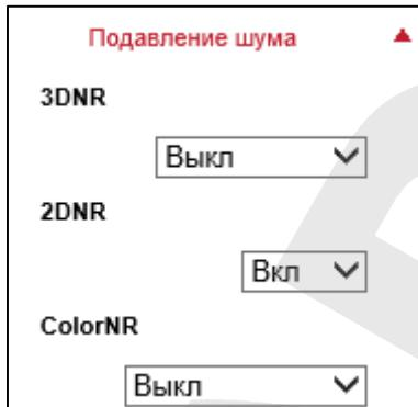
Использование данной функции позволяет снижать уровень шума при низкой освещённости. Фильтр 3DNR рассчитан для сцен со статической картинкой. Фильтр 2DNR используется для фильтрации шумов на сценах с динамической картинкой. Фильтр ColorNR используется для подавления цветовых шумов.
