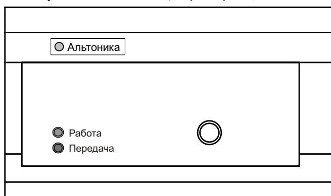
Кнопка при работе передатчика не используется: ее контакты не подключены. Зеленый светодиод РАБОТА горит, когда передатчик включен, и мигает во время получения сигнала от панели. Красный светодиод
