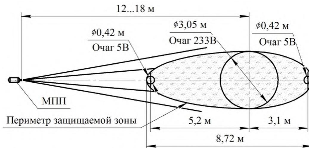
Рисунок 5 – Масштабное изображение защищаемой площади при локальном пожаротушении
