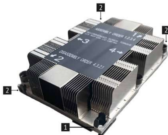
Рис. 37. Снятие процессора с радиатора
