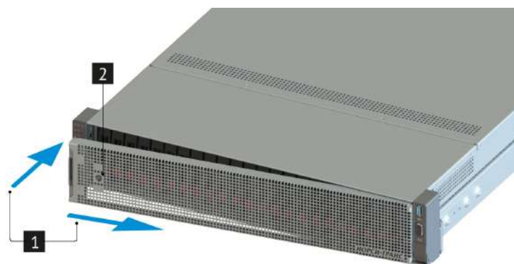
Рис. 21. Установка передней панели
