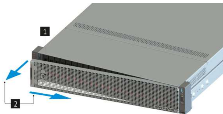
Рис. 20. Снятие передней панели
