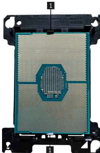
Рис. 38. Снятие процессора с радиатора
