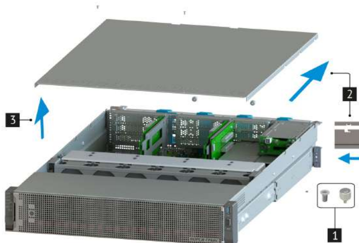
Рис. 22. Снятие верхней крышки платформы
