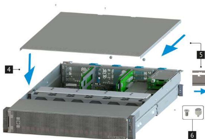
Рис. 23. Установка верхней крышки платформы
