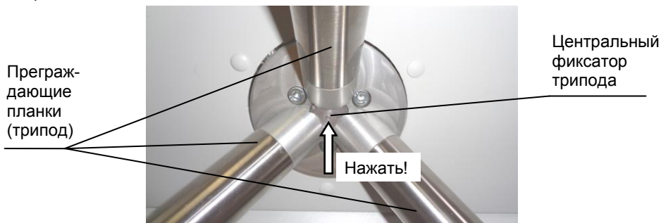
Рис.3 Место расположения центрального фиксатора трипода
