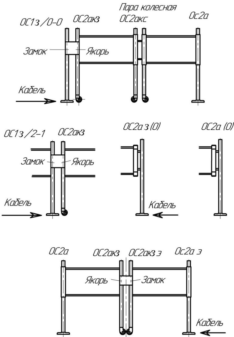
Рис. 9. Виды стоек ограждений с электромагнитным замком
