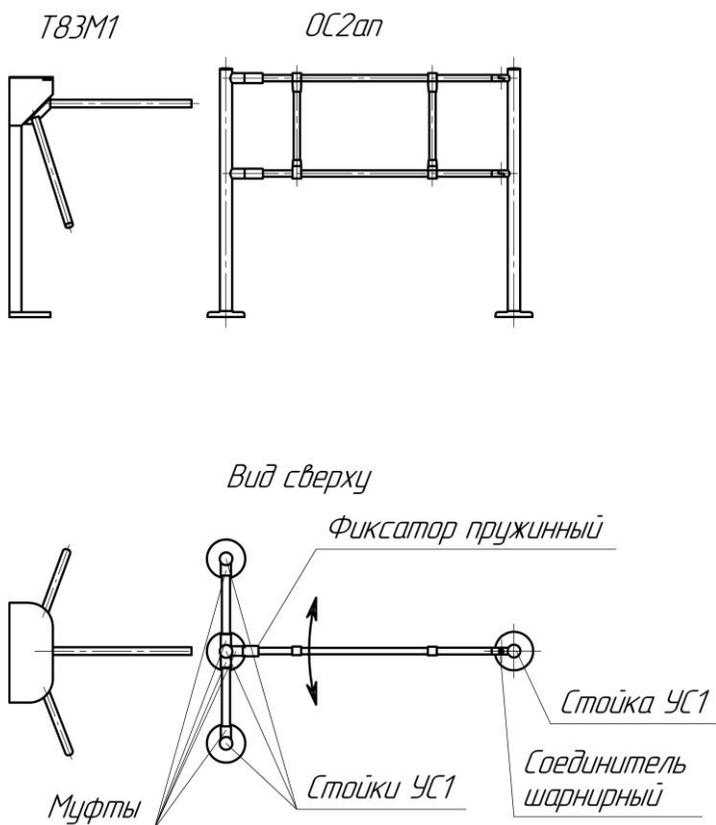
Пример компоновки ограждения ОС1 и ограждения антипаники ОС2ап с турникетом-триподом Т83М1
