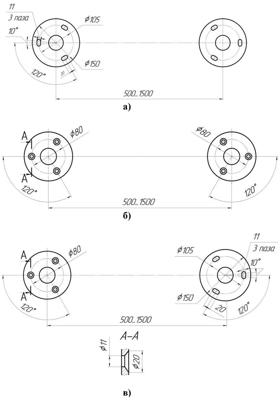
Рис. 11. Установочные размеры стоек стационарных ограждений:
