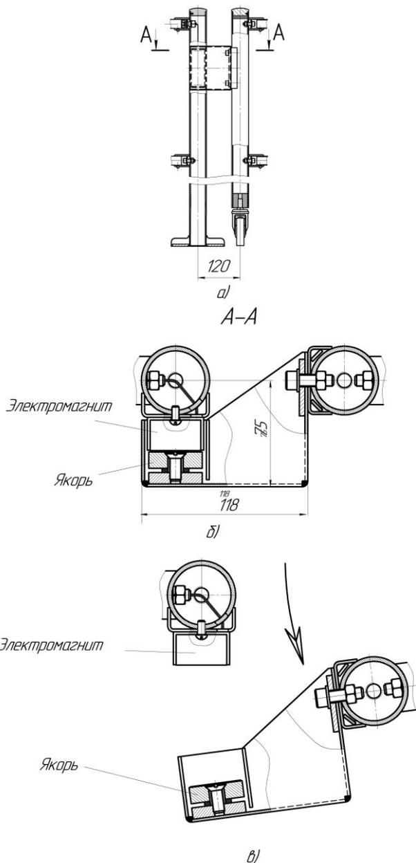
Рис. 8. Варианты электромагнитного замка: а) замок на стойке ограждения ОС1; б) вид сверху замок закрыт; в) замок открыт
