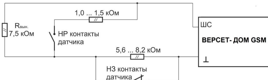
Рис.12. Схема включения технологических датчиков в ШСТ.
