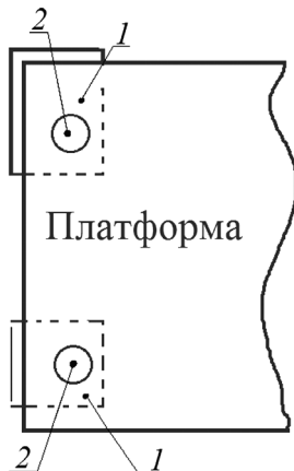
Рисунок 4. Установка пандусов и платформ на плиты закладные ограничительные 1 – плита закладная ограничительная, 2 – гнездо.
