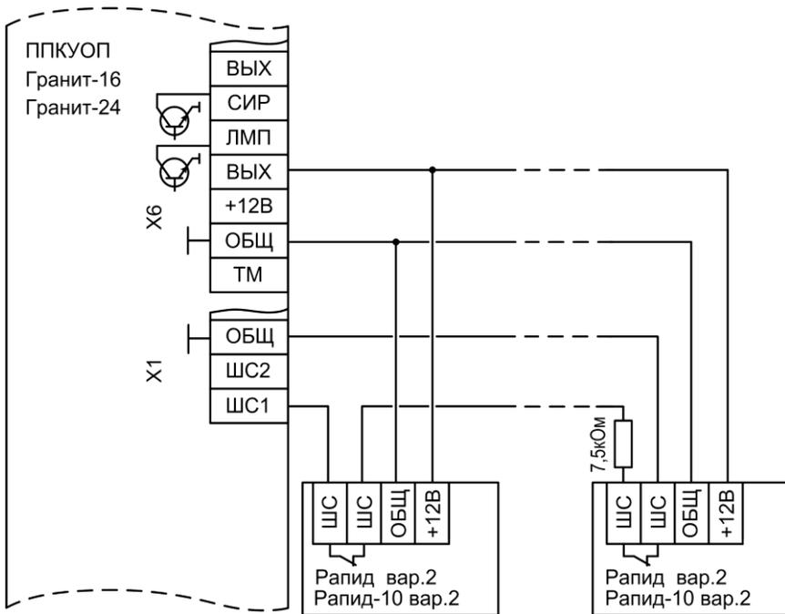
**Рис.А5** Схема подключения охранных извещателей
