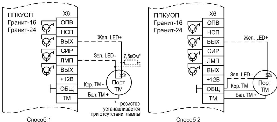
**Рис.А3** Схемы подключения порта Touch Memory
