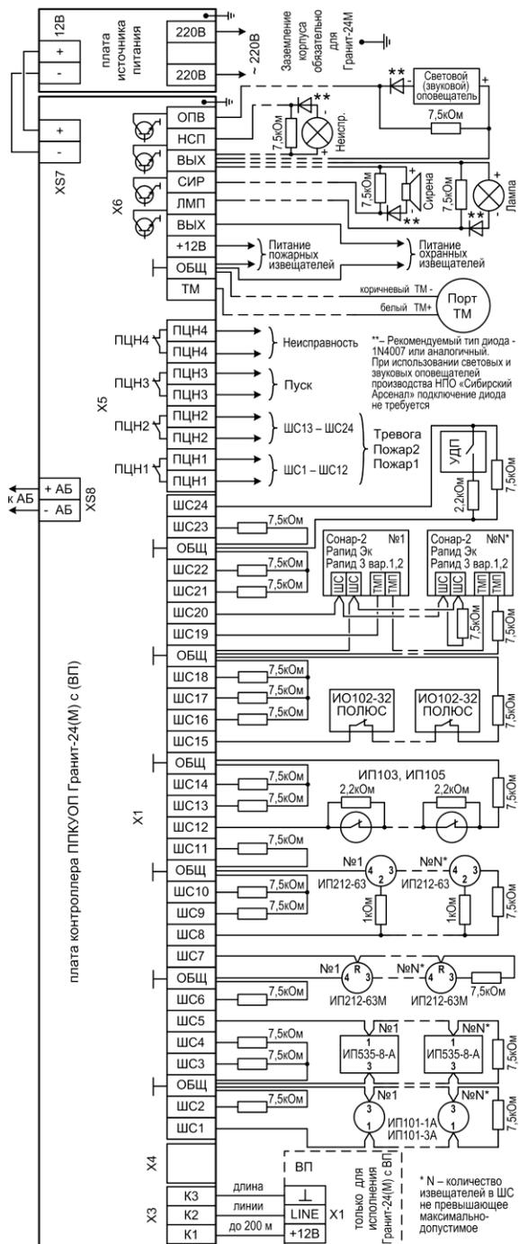
Рис.А2 Схема внешних подключений ППКУОП Гранит-24(М) с (ВП)
