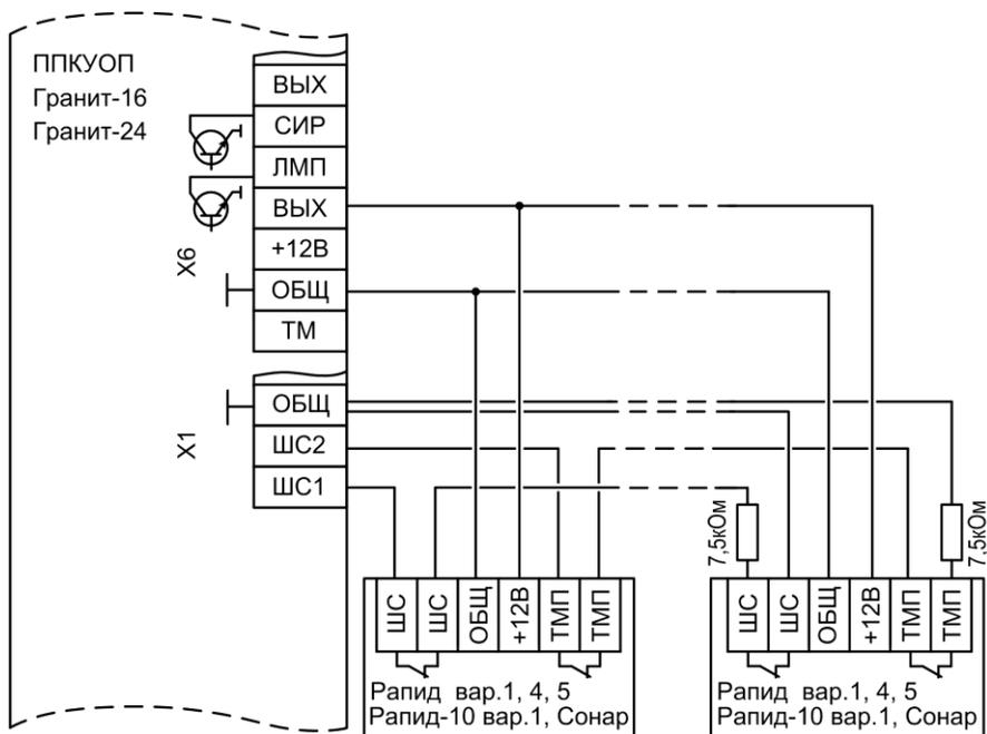
**Рис.А4** Схема подключения охранных извещателей
