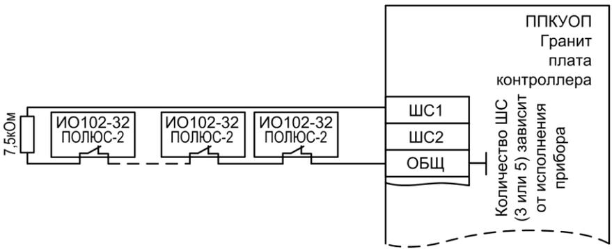
**Рис.Б4** Схема подключения охранных магнитоконтактных извещателей
