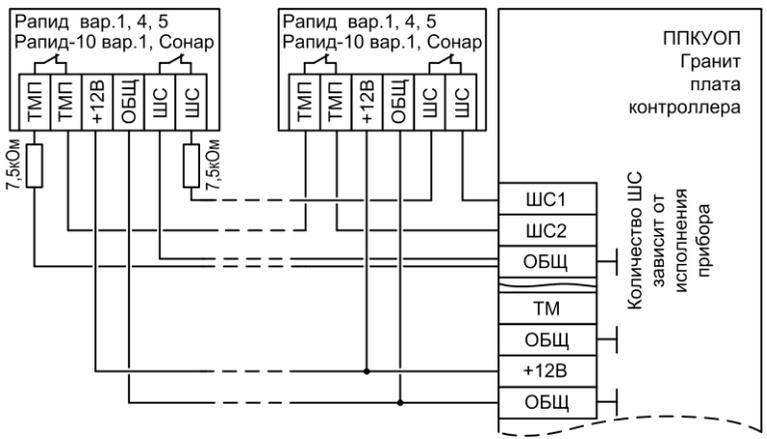
**Рис.Б5** Схема подключения охранных извещателей Rapid вар.1,4,5, Rapid-10 вар.1, Сонар (тампер подключён к отдельному ШС)
