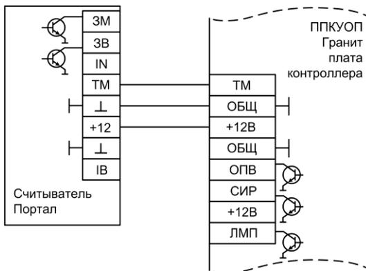
**Рис.Б7** Схема подключения считывателя «Портал»
