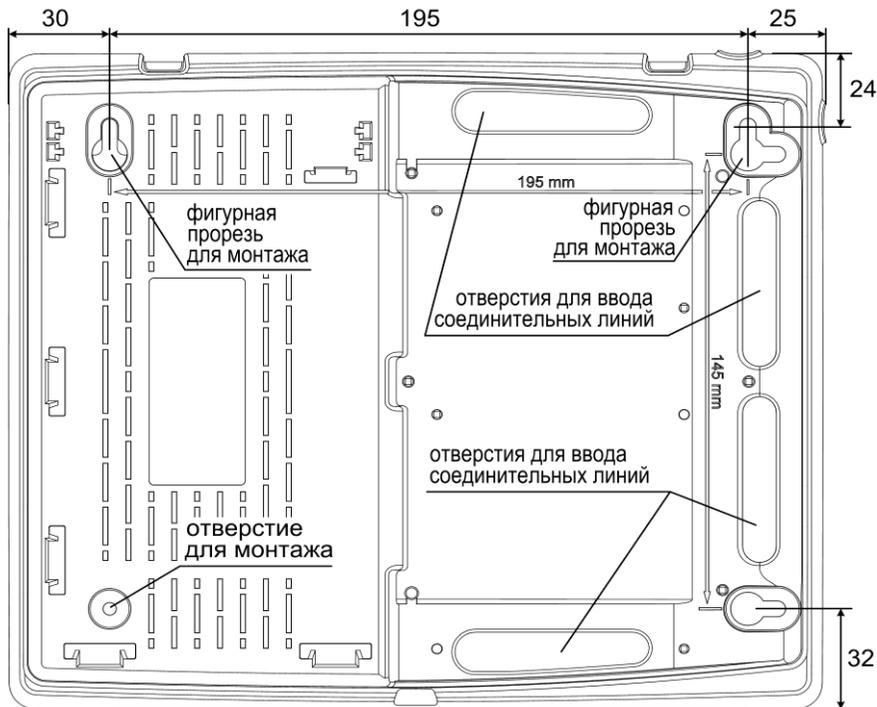
Рис.3 Задняя стенка прибора. Присоединительные размеры
