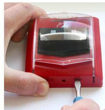
Для включения питания извещателя удалите (вытащите) бумажную ленту, изолирующую контакт основной батареи извещателя. Резервная батарея установлена и готова к работе.
