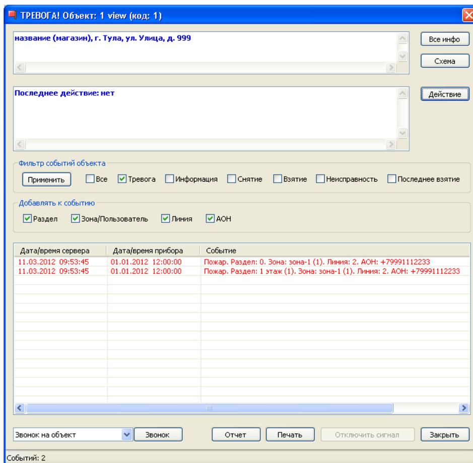
Заголовок окна содержит краткую информацию об объекте, на котором сработала тревога: его уникальное имя и код. Ниже следует окно с более подробными данными объекта. В расположенном под ним окне представлены данные о последнем произведенном действии по реагированию на тревоги объекта. В нижней части окна расположены настройки списка отображения тревог объекта и сам список тревог. События данного списка выводятся в порядке убывания даты их возникновения.
