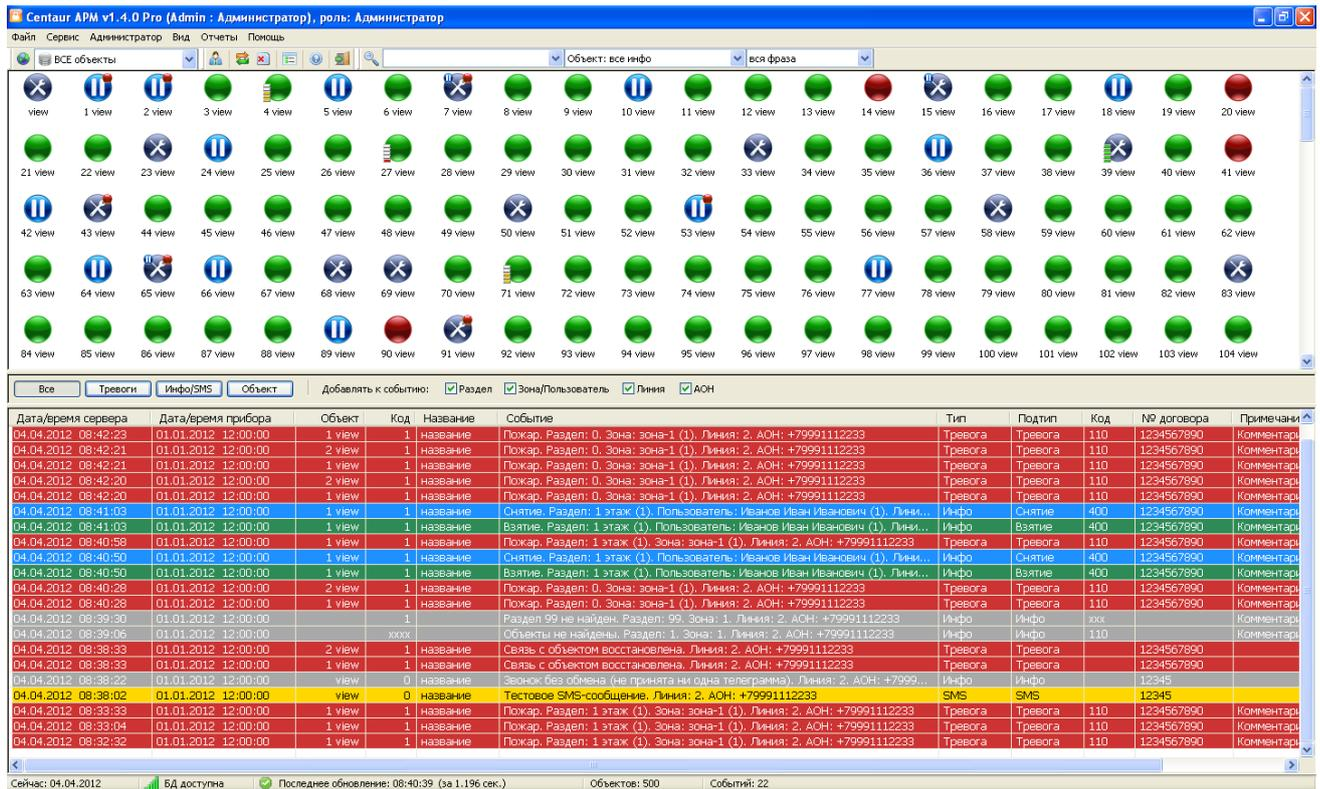
Заголовок окна содержит данные текущего пользователя системы. В верхней части окна расположены текстовое и графическое меню для быстрого доступа к основным функциям программы, а так же панель поиска. Нижняя часть окна содержит статусную строку для отображения вспомогательной информации. Центральная часть окна разбита на три области: **список объектов, панель настройки списка событий и список событий.**
