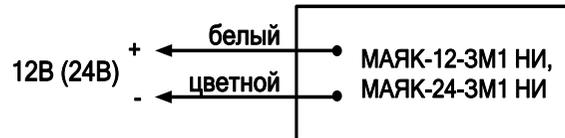
Рис.1. Схема подключения.
