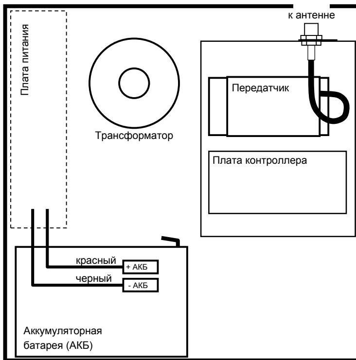
Рис. 1. Компоновка основного блока прибора
