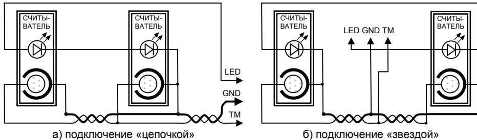
Рис. 7. Подключение двух считывателей
