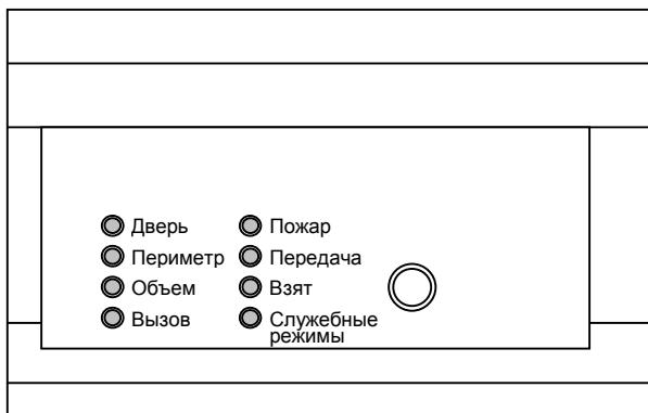
Рис. 2. Внешний вид выносного блока индикации
