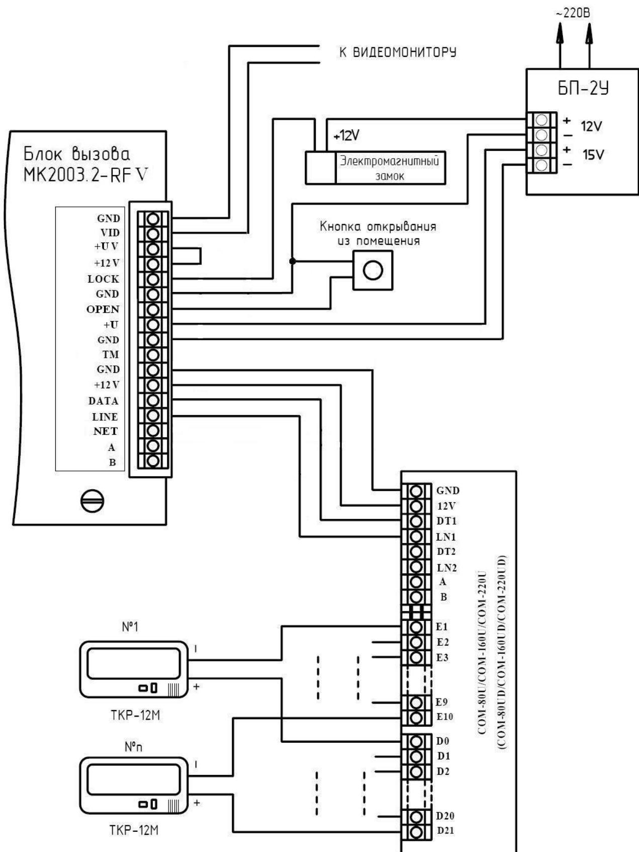
Рис. 2 Пример монтажа блока вызова MK2003.2-MFV
