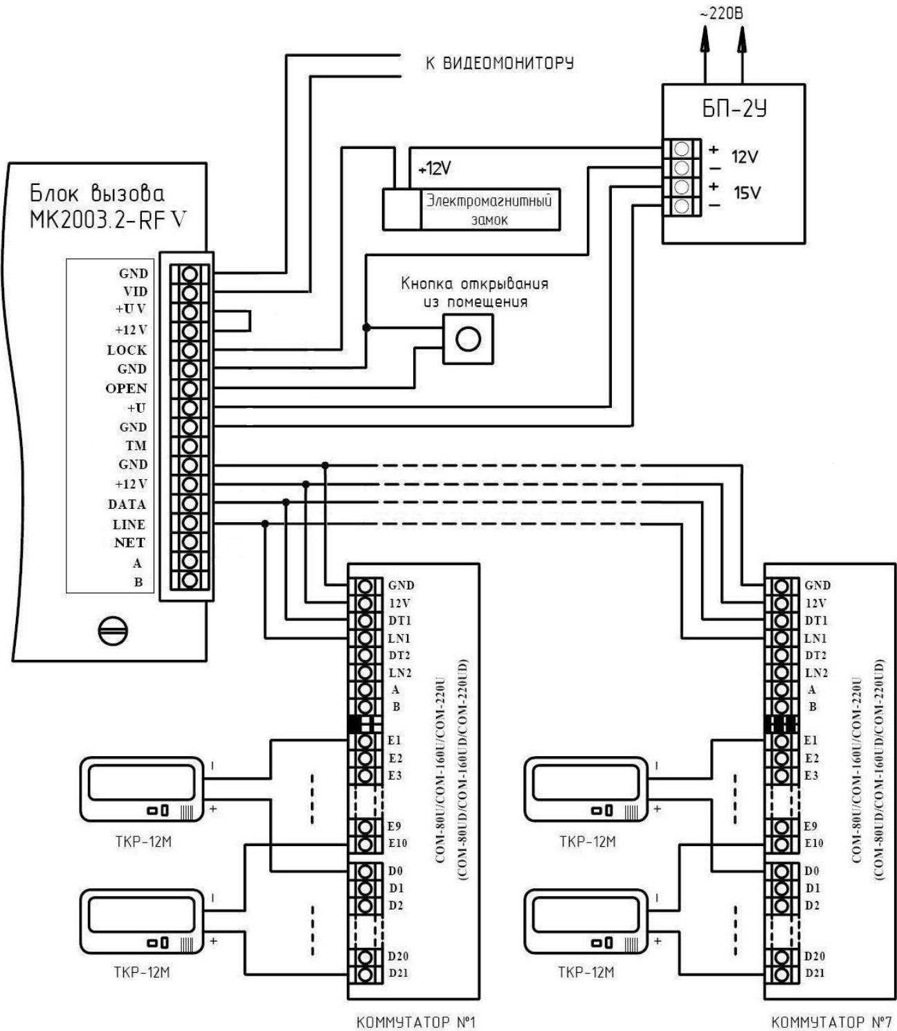
Рис. 3 Пример монтажа блока вызова MK2003.2-MFV при использовании нескольких коммутаторов.
