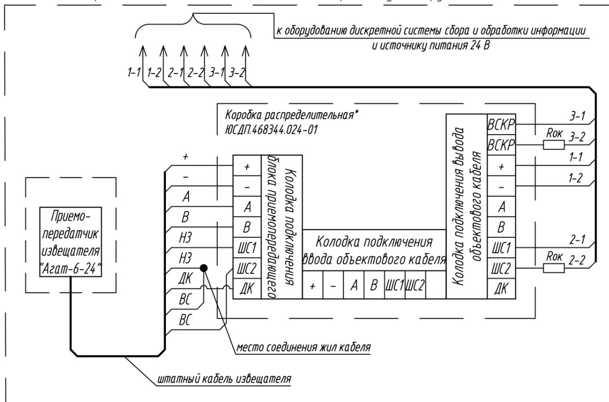
Вариант подключения извещателя к ССОИ по интерфейсу RS-485
