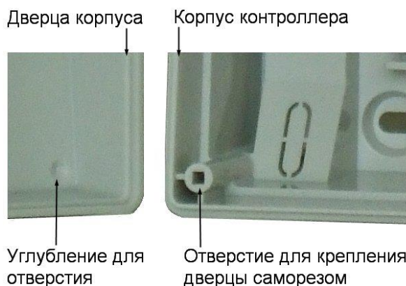
Рисунок 5. Система «жесткого» крепления дверцы к корпусу контроллера
