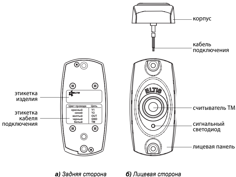
Рис.1 Внешний вид блока электронного ключевого устройства CRT-51
